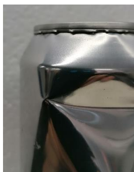
Bördelrolle 1 ist zu weit entfernt.
